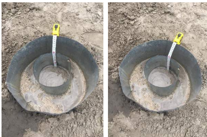
图 5.3.6-1 双环渗水实验现状照片
